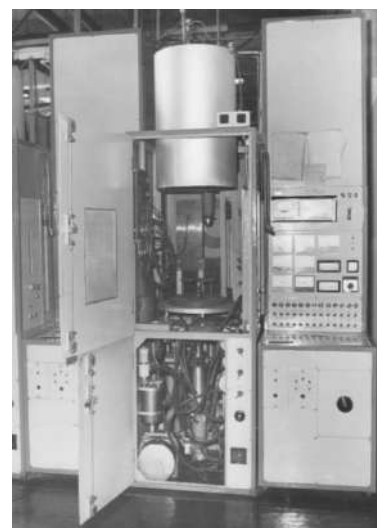
Stanowisko próżniowe TP26 do lamp T6 z zunifikowanym urządzeniem pompowym.
