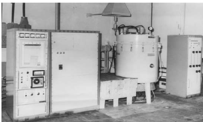
Urządzenia piecowe TG19B. Od lewej: zespół sterowania UA1, zespół zasilania ZG2, wodorowy piec wgłębny UG18 i zespół gazowy UP1.
