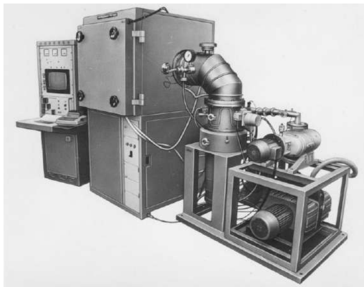
Urządzenia piecowe TG25. Od lewej: zespół sterowania UA7, próżniowy piec komorowy UG32 (u góry), zespół zasilania ZG9 (na dole) i zespół próżniowy UP3.
